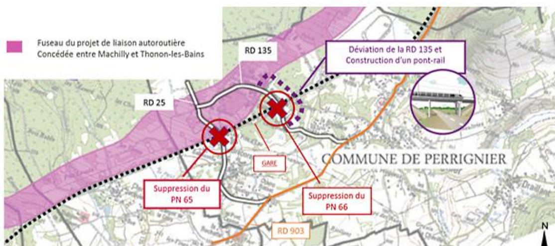
Configuration 2 – Solution 2a - Pont-rail légèrement au nord-est du PN n°66 actuel et fermeture définitive du PN n°65
